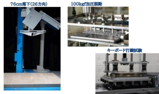
落下や振動といったMIL規格(MIL-STD-810H)のみならず、実際の利用シーンを想定した厳しい判断基準での独自試験を実施
